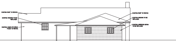
③ ELEV: EXISTING REAR ELEVATION Scale: 1/8" = 1'-0"
